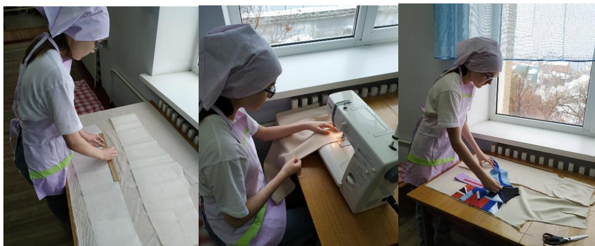
Рисунок 9 – Раскрой и монтаж изделия
