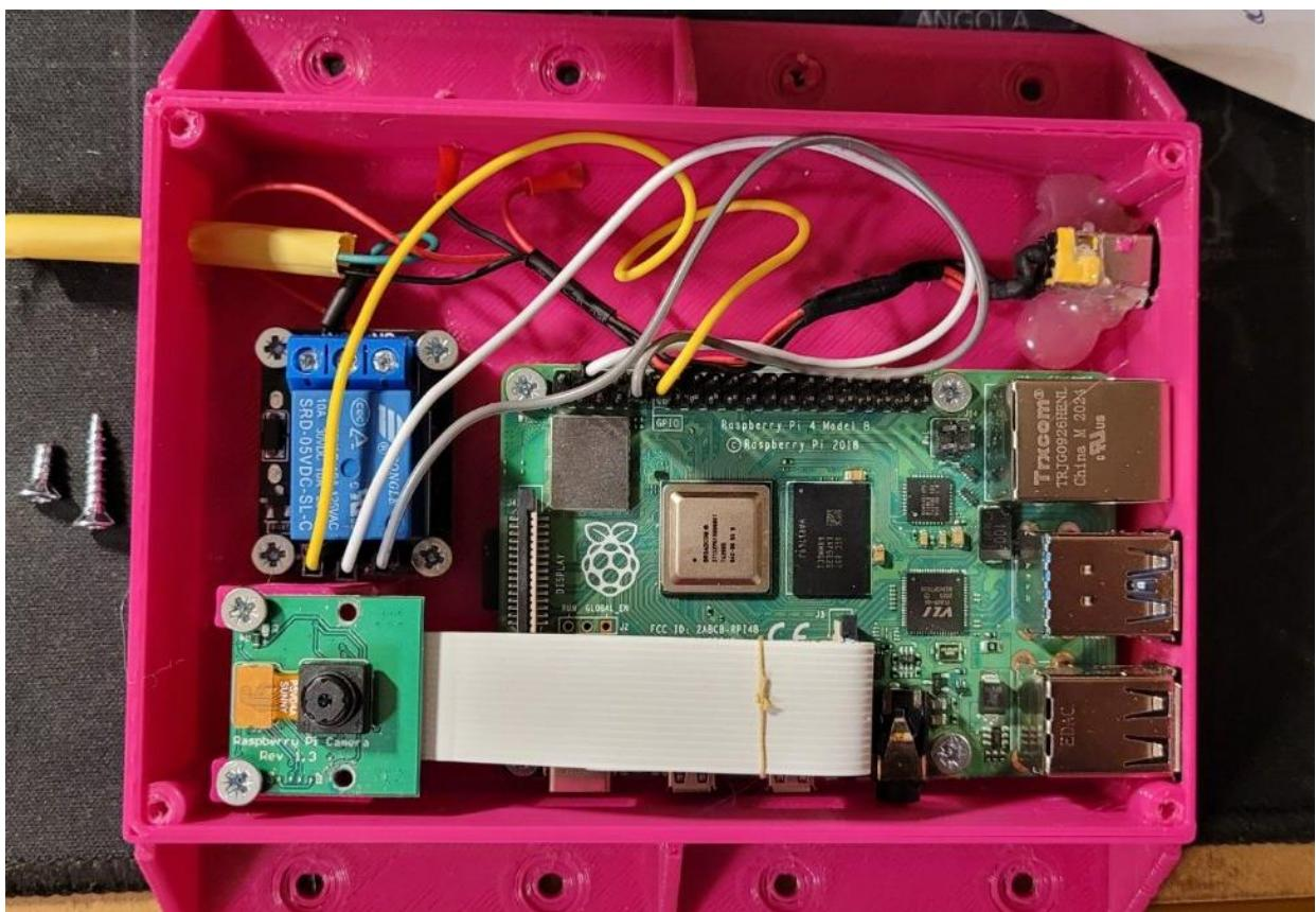
Рисунок 14 – Компоновка деталей и проводных соединений
