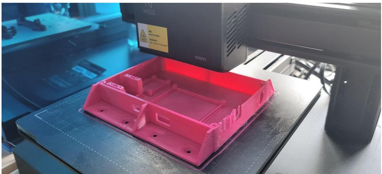
Рисунок 10 – Процесс изготовления корпуса
