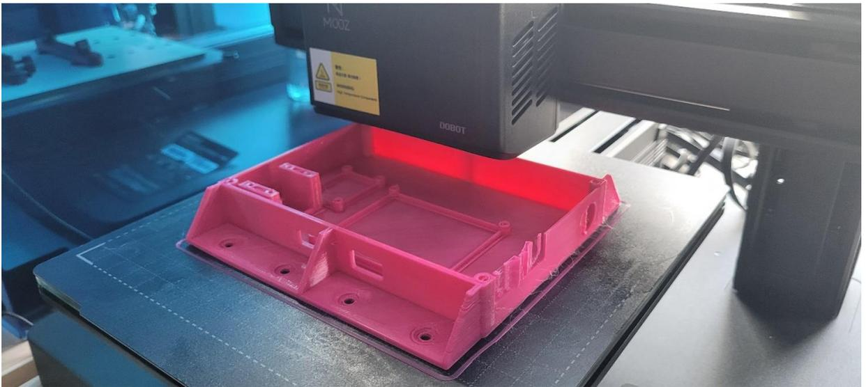
Рисунок 10 – Процесс изготовления корпуса
