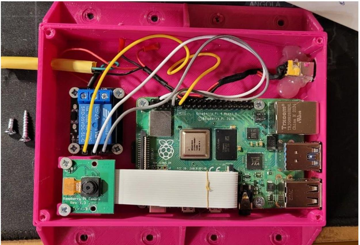
Рисунок 14 – Компоновка деталей и проводных соединений
