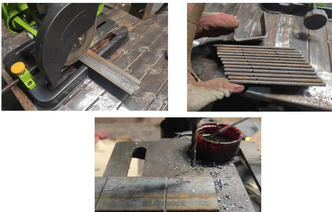
Рисунок 14 - Резка металла
