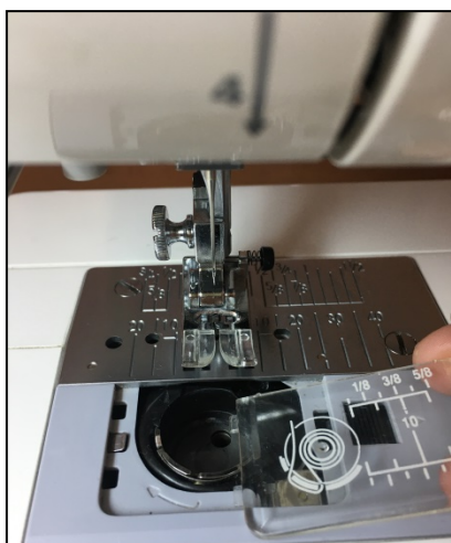
а) снятие пластины, закрывающей челнок в машине с горизонтальным челноком
