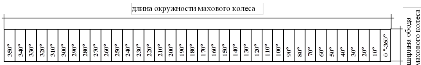
Рис.2. Шкала измерения угла поворота главного вала машины
