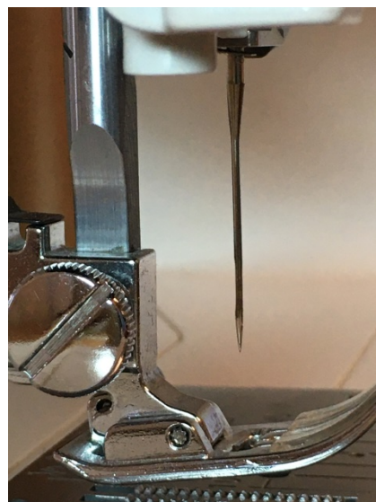
Рис. 4. Установка иглы в крайнее верхнее положение
