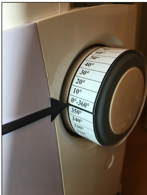
Рис. 5. Прикрепление шкалы измерения на маховое колесо
