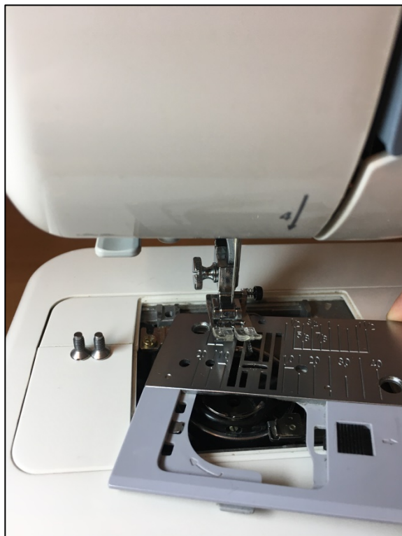
Рис. 8. Снятие игольной пластины
