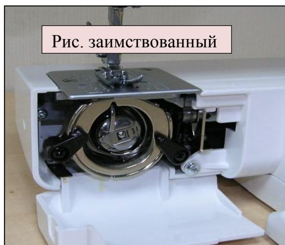
б) открытие крышки, закрывающей челнок в машине с вертикальным челноком
